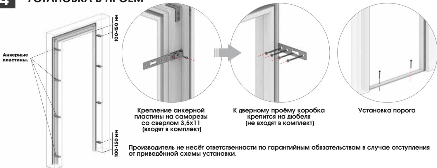
Крепление анкерной пластины на саморезы со сверлом 3,5x11 (входят в комплект)
