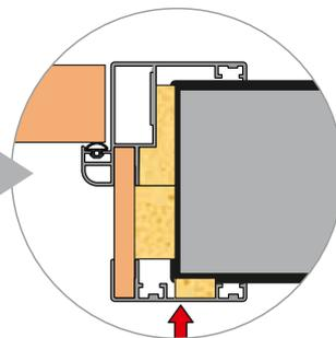
Рекомендуем точно наносить монтажную пену на тыльную сторону наличника перед его установкой, что дополнительно приклеит его к стене, но даст возможность демонтировать его в случае необходимости.
